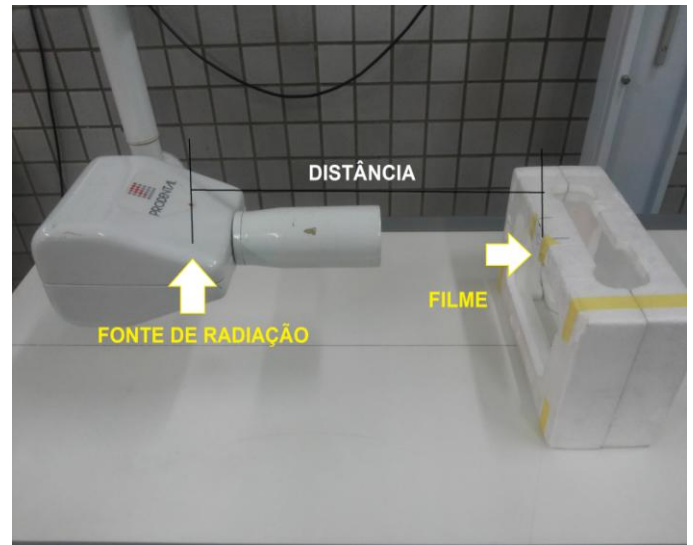
Figura 4: Filmes posicionados em diversas distâncias da fonte de radiação (Arquivo próprio).
