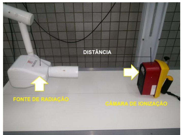
Figura 5: Câmara de Ionização e fonte de radiação posicionadas (Arquivo próprio).
